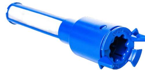
Das erzeugte Magnetfeld im Einfüllstutzen öffnet den Magnetschalter im Auslaufrohr. Ein Befüllen anderer Kraftstofftanks mit AdBlue ist dadurch ausgeschlossen. Dies kann dazu beitragen, Fehlbetankungen und damit verbundene Schäden am Fahrzeug zu vermeiden.
